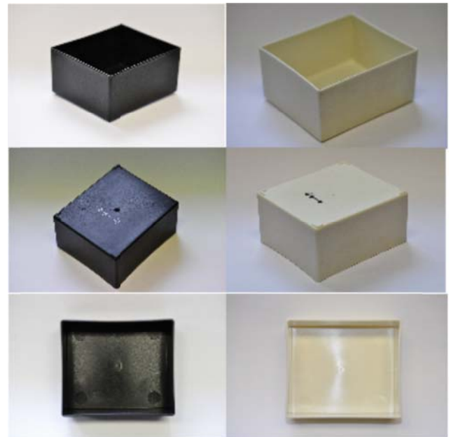
Abbildung 3: Kastenbauteil, PA GF 20 mit Ruß (links) und PBT GF 20 (rechts) mit zentralem Anguss an der Bodenunterseite
